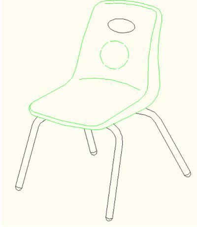
Para la unión de elementos metálicos se aplicará soldadura de microalambre sistema mig, sin escoria.
